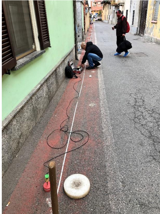
Figura 11: esecuzione dello stendimento sismico
