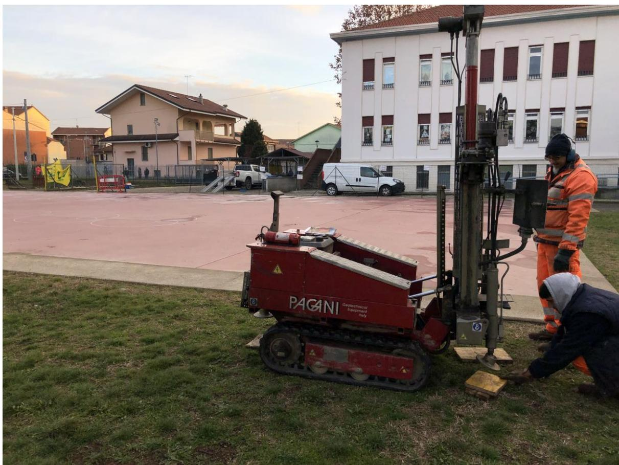
**Figura 8: posizionamento del penetrometro per l'esecuzione della seconda prova**
