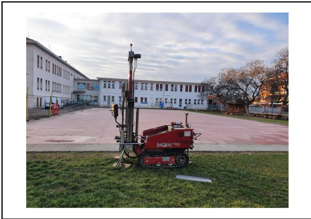
**Foto 1:** Posizionamento prova penetrometrica dinamica DPSH1.
