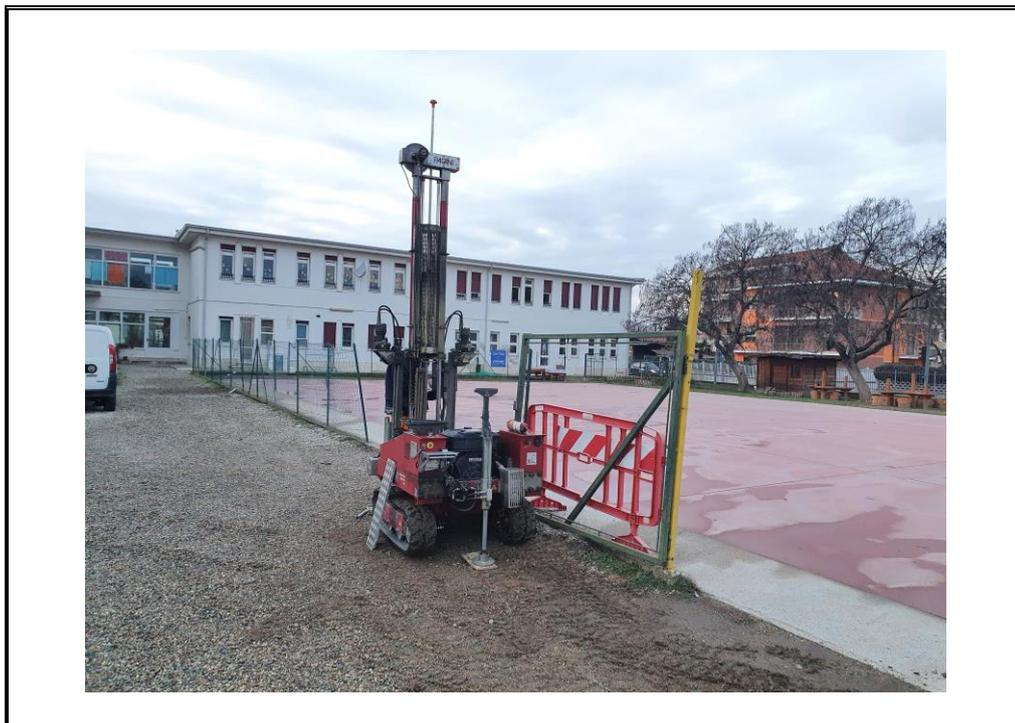
**Foto 3:** Posizionamento prova penetrometrica dinamica DPSH3.
