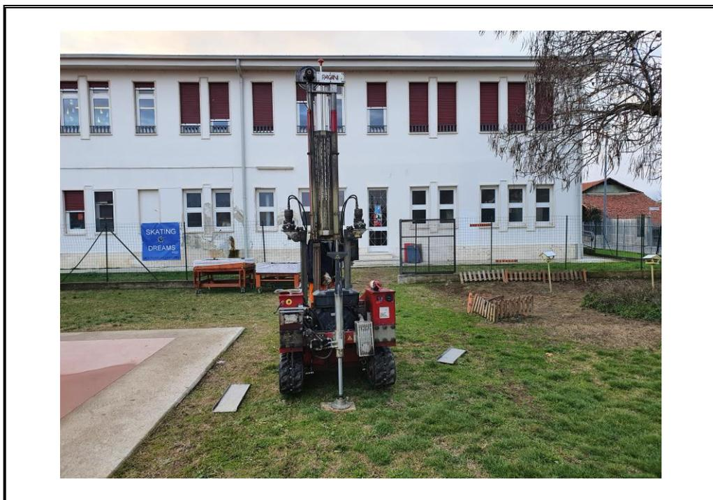
**Foto 2:** Posizionamento prova penetrometrica dinamica DPSH2.
