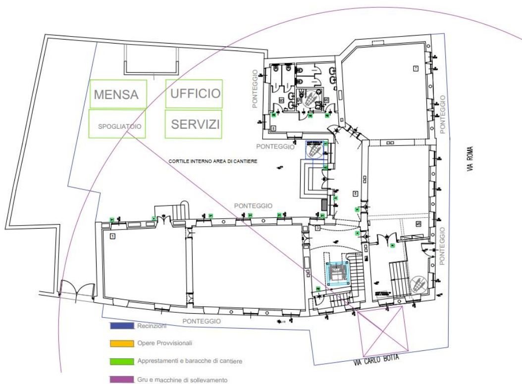
Figura 2 – Layout di cantiere
