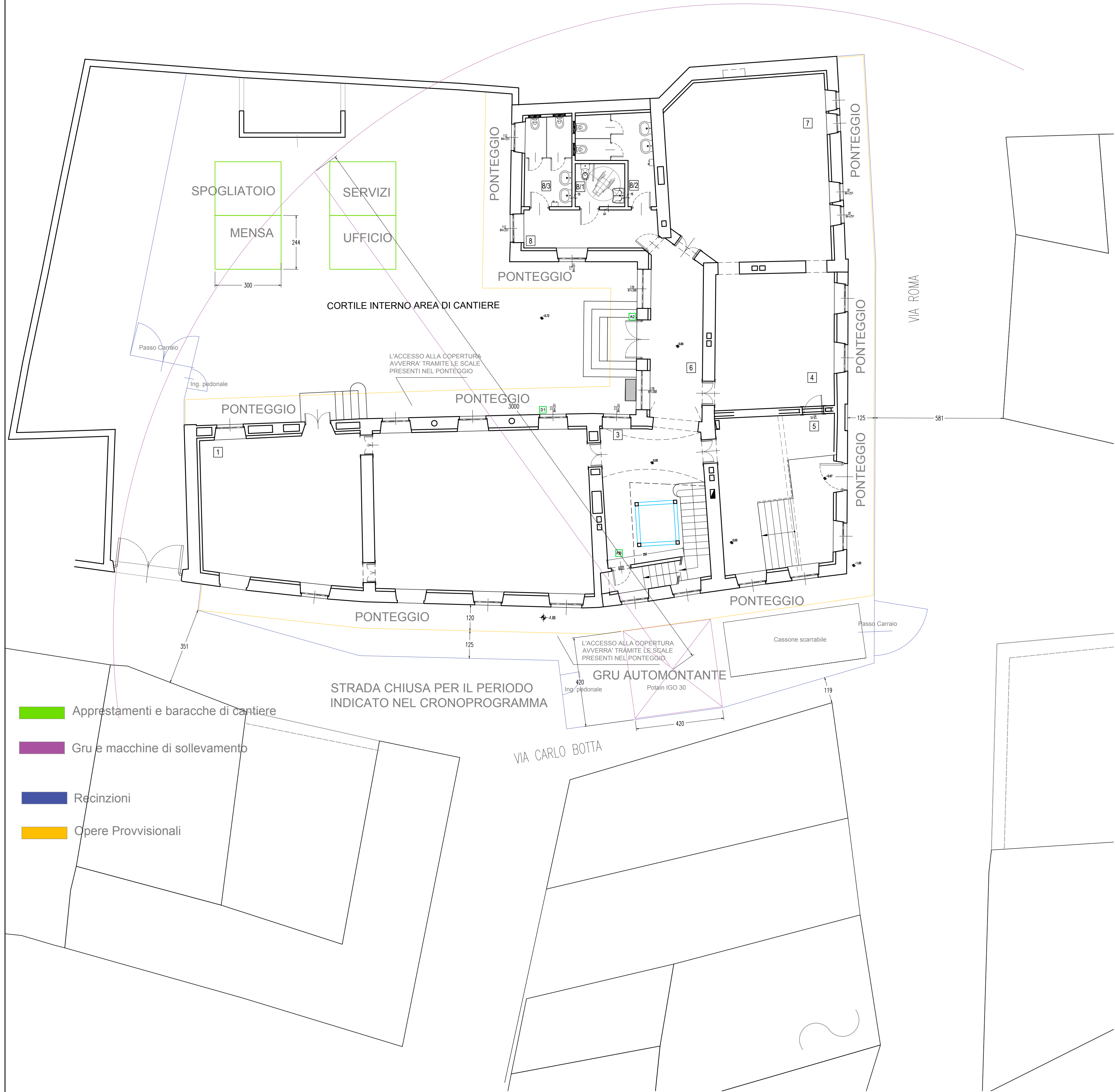
SECOND FASE RIFACIMENTO TETTO E RESTAURO FACCIATA
